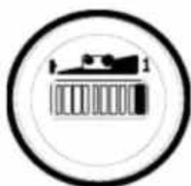
Батарея полностью заряжена
