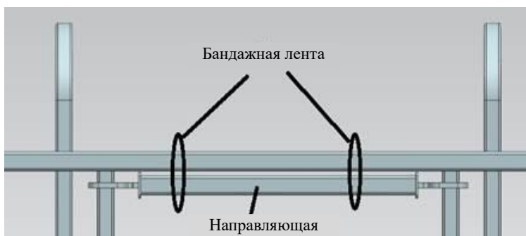
Рис. 4-7 Схема крепления направляющей рабочей платформы
