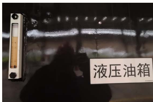
Рис. 5-2 Указатель с круговой шкалой гидравлического бака
