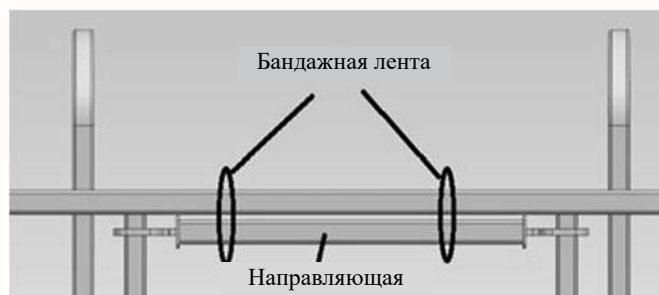
Рис. 4-3 Схема крепления направляющей рабочей платформы
