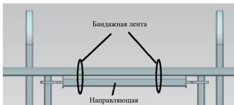
Рис. 4-3 Схема крепления направляющей рабочей платформы
