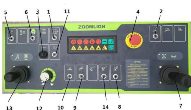
Рис. 2-12 Платформенная панель управления (отмечены только номера переключателей, которые имеют соответствующие функции)
