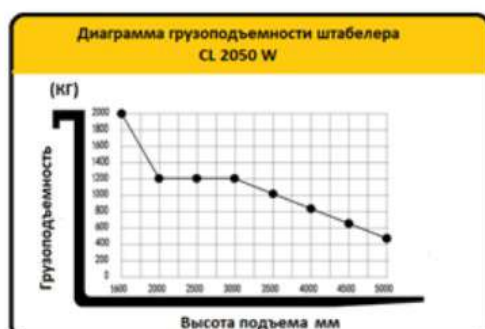
Рисунок 5. Диаграмма грузоподъемности штабелера.
