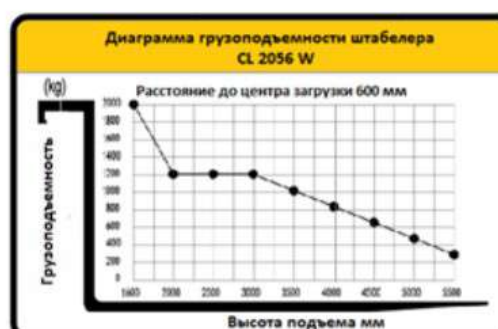
Рисунок 5. Диаграмма грузоподъемности штабелера.
