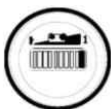
Батарея полностью заряжена
