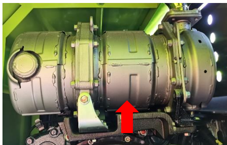
Рис. 5-14 DPF Фильтрующий элемент
