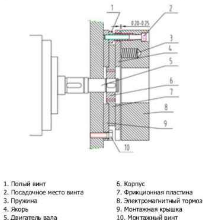
Рисунок 10. Регулировка зазора.
