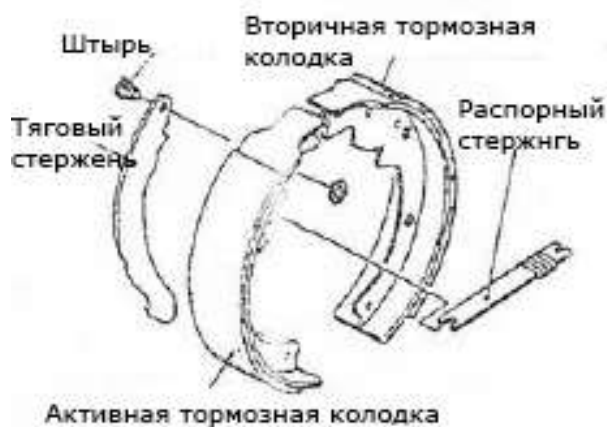
Рис.3-7 Устройство стояночного тормоза
