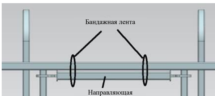
Рис. 4-7 Схема крепления направляющей рабочей платформы
