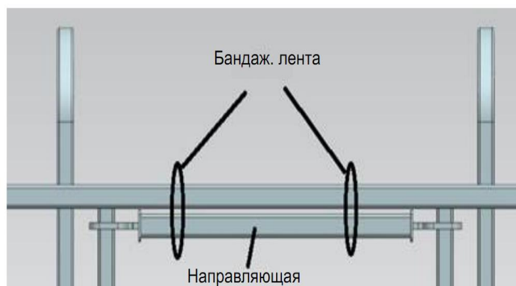
Рис. 4-3 Схема крепления направляющей рабочей платформы
