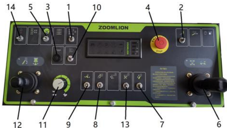
Рис. 2-9 Платформенная панель управления (отмечены только номера переключателей, которые имеют соответствующие функции)
