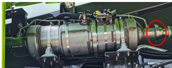
Рис. 5-23 Хомут, соединяющий выхлопную трубу и устройство для последующей обработки
