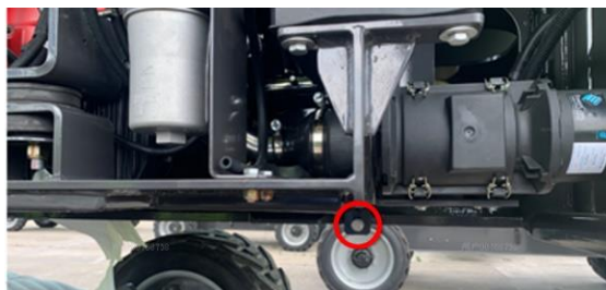
Рис. 5-25 Болты, соединяющие кронштейн с поворотной платформой,
