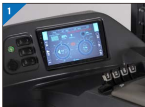
1 СОВРЕМЕННАЯ КОНСОЛЬ Большой сенсорный немецкий дисплей ELOBAU
