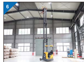
6 СИСТЕМА АКТИВНОЙ СТАБИЛИЗАЦИИ При движении мачты вперед/назад, рабочий тормоз срабатывает автоматически, обеспечивая стабильность работы
