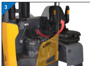
3 ЛЁГКИЙ СЕРВИС Удобное снятие крышки и открытая архитектура
