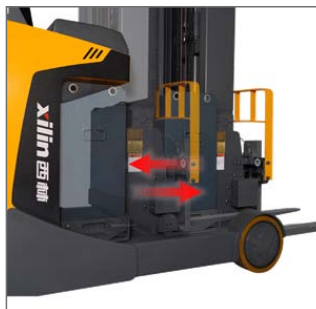
Боковая замена АКБ на роликах - выдвигание вместе с мачтой
