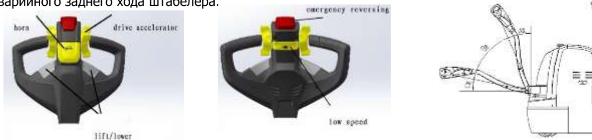
Рис.6 - Работа аварийного заднего хода штабелера
