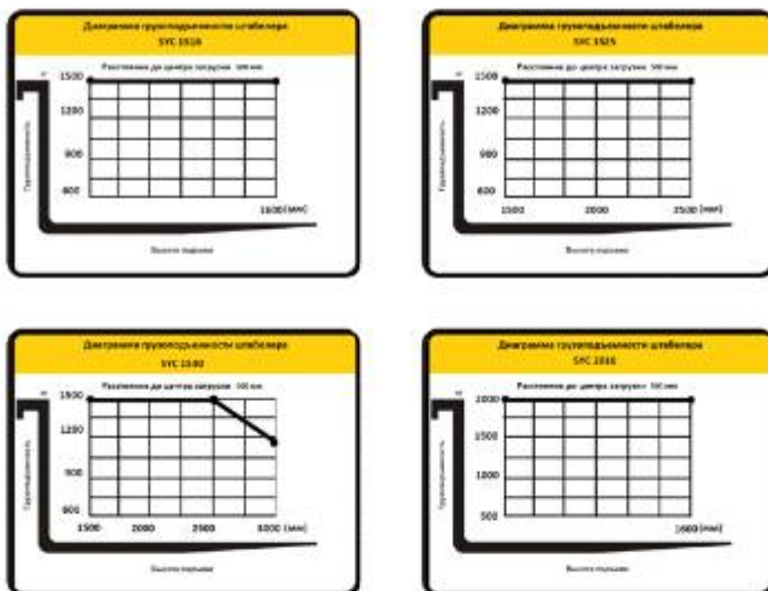
Рисунок. 4. Диаграмма грузоподъемности штабелера.
